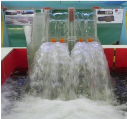
Figura 1. Vista desde aguas abajo, vertederos de excesos en funcionamiento e impacto de los chorros en el cuenco amortiguador, modelo físico de la presa Toachi.
