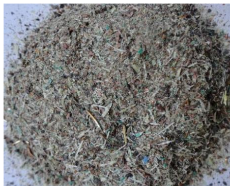
Figura 1. Fracción metálica obtenida después de la separación gravimétrica
