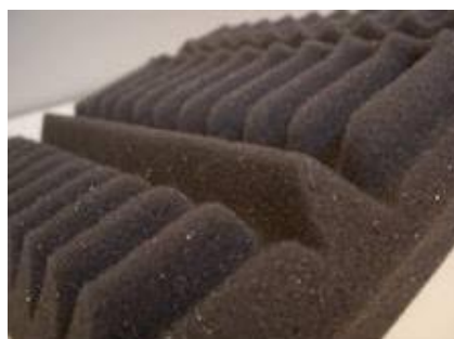
Figura 6. Sonex de 35 mm dispuesto como material absorbente entre el techo y el cielorraso
