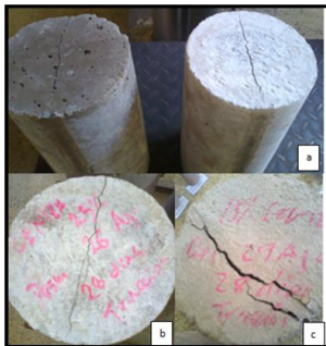
Figura 5. Proceso de fisuramiento en tracción indirecta
