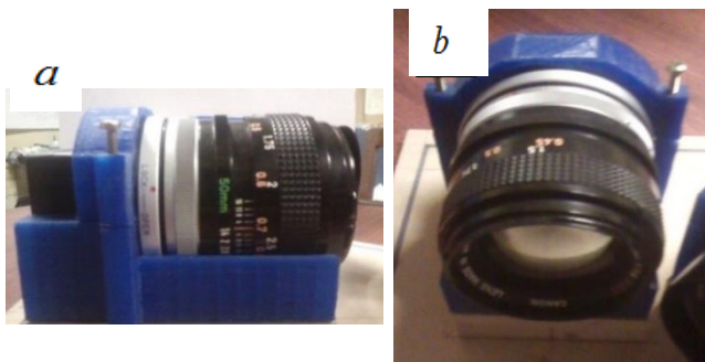
Figura 13. Base de sujeción objetivo 50mm y Cámara CCD, vista lateral (a) y vista frontal (b).
