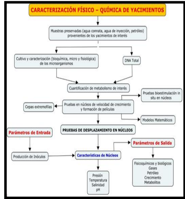
Figura 1. Diagrama del proceso de inyección bacteriana en la recuperación de petróleo.
