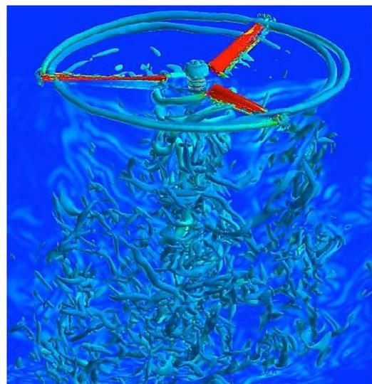
Figura 13. Efecto de circulación producido por las hélices del dron (Yoon et al. 2017)
