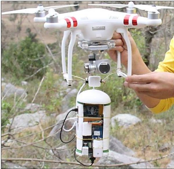
Figura 11. Sistema móvil listo para el sobrevuelo.
