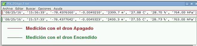
Figura 14. Comparación de mediciones con el dron apagado y encendido.
