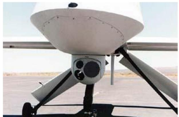
Figura 1. UAV equipado con un Sistema Electro-óptico
