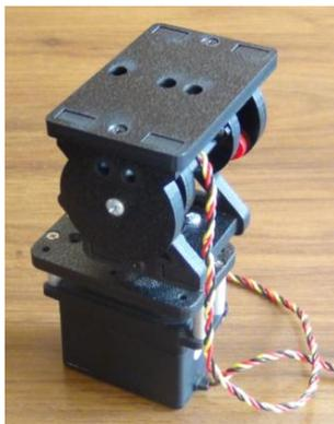
Figura2. Estructura Pan &Tilt ensamblada
