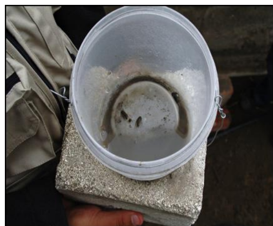
Fig. 12: Cenizómetro, recipiente de plástico transparente que permite la recolección de ceniza (Foto: J. Bustillos-IG).
