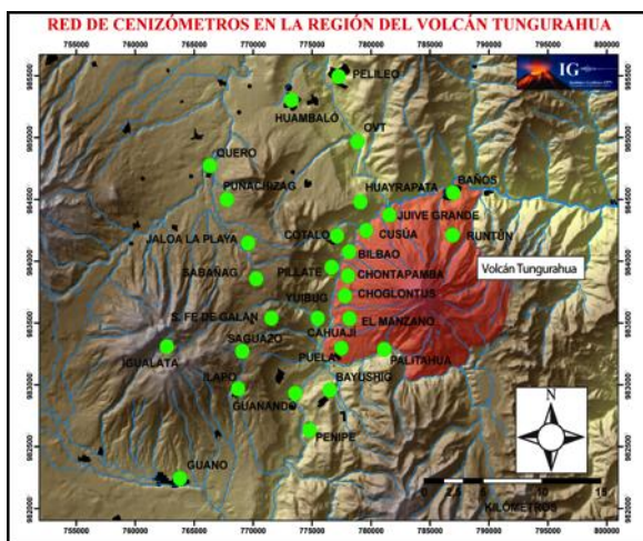
Fig. 11: Red de colectores de ceniza alrededor del volcán Tungurahua instalada el 27 de marzo de 2007 (Modificado de [10]).
