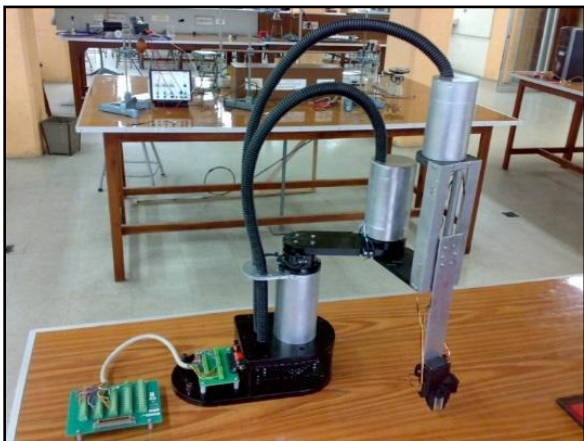
Figura 10. Robot SCARA completo con módulo de entradas y salidas.
