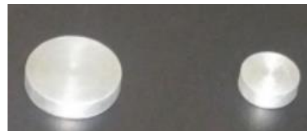
Figura 4. Probeta cilíndrica que se utilizó para los ensayos de espectroscopía por chispa y para obtener las metalografías
