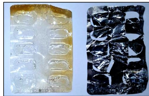
Figura 5. Blísteres que presentaron resultados excepcionalmente buenos, a la derecha se observa la lámina de aluminio separada del polímero después del procesamiento
