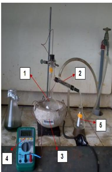
Partes del equipo de destilación para obtención de biocombustible:
