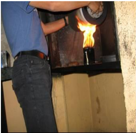
Figura 2. Ahumado de Tambor de registro sísmico.
