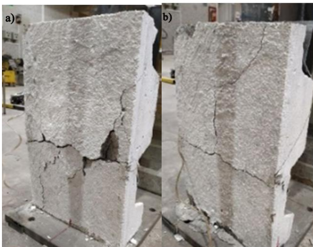
Figura 2. Fallo del hormigón. a) Rotura del hormigón en la probeta C1-45-4 mm. b) Rotura del hormigón en la probeta D1-90-4 mm.
