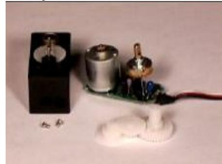
Figura 10. Componentes de un servomotor. [12]
