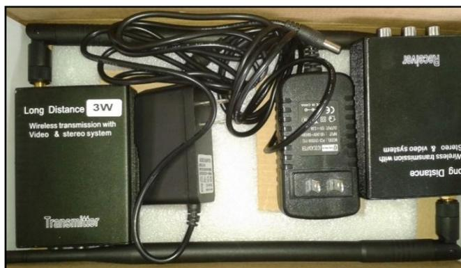
Figura 5. Transmisor y receptor de radiofrecuencia.
