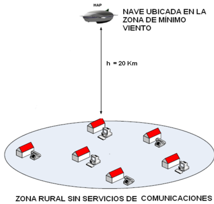
Figura 10. Altura ideal de posicionamiento de la PGA para que se ubique en la zona de mínimo viento.
