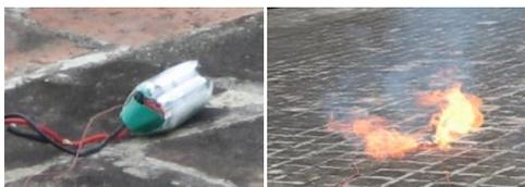
**Figura 7.** Hinchazón y explosión de una batería LiPo.
