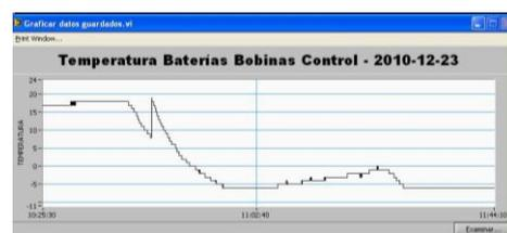
Figura 12. Curva de temperatura del sistema de energía durante la prueba en la cámara de bajas temperaturas.
