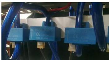
Figura 10. Sensores de corriente de tipo efecto Hall.
