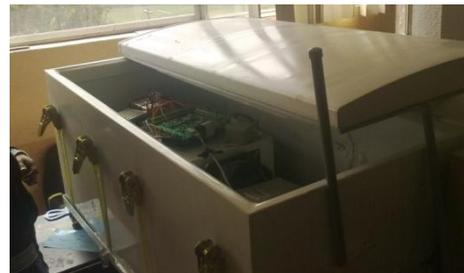
Figura 11. Cámara de bajas temperaturas con elementos del sistema de control de energía en su interior.
