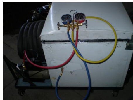
Figura 11. Bomba de vacío y manómetros.
