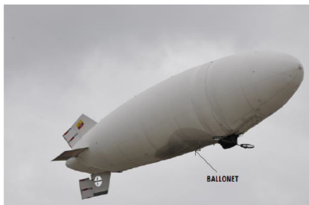
Figura 1. Dirigible de 9 metros y en su interior un ballonet.
