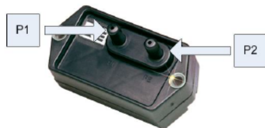
Figura 4. Sensor de presión diferencial.
