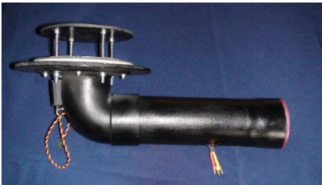
Figura 5. Válvula y bomba de aire.
