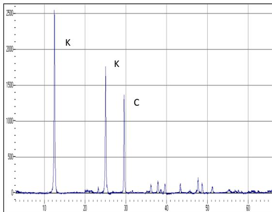
**Figura 2.** Difractograma de la fracción arcillosa obtenida por centrifugación (mezcla 40 % caolín) K: caolinita, C: calcita
