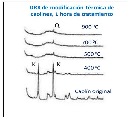
**Figura 6.** Comparación de patrones DRX para caolines modificados térmicamente
