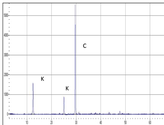
**Figura 3.** Difractograma de la fracción arcillosa obtenida por ultrasonido (mezcla 40 % caolín) K: caolinita, C: calcita
