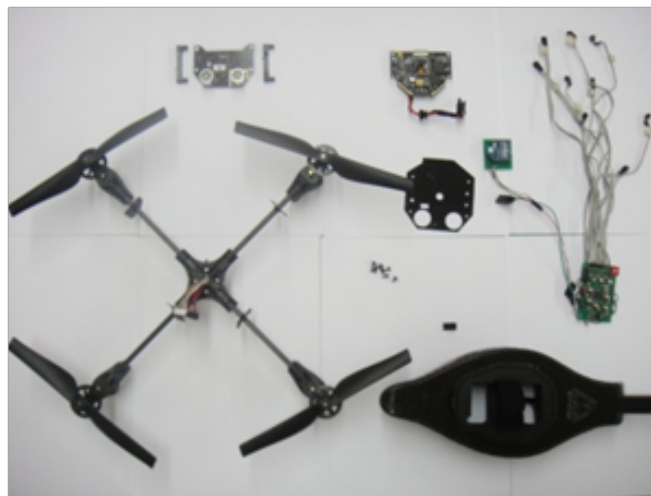
Figura 3: Partes constitutivas del quadricóptero Parrot A.R Drone.
