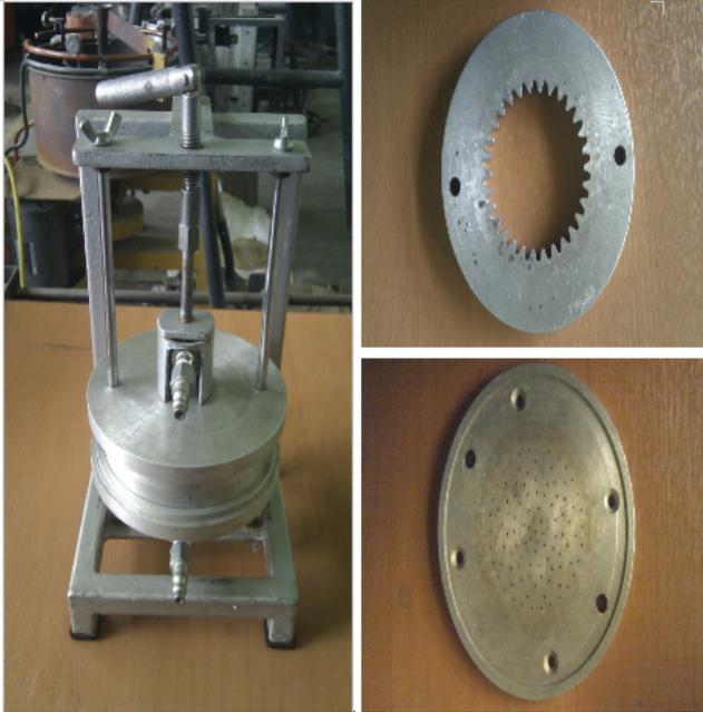
Figura 2: Matriz de aluminio para obtención de modelos EPS.
