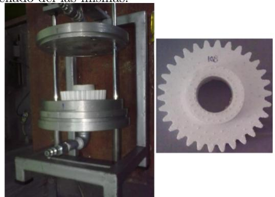
Figura 6: Extracción de modelo.
