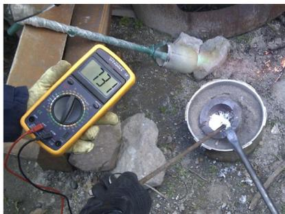
Figura 9: Verificación de temperatura de colado.
