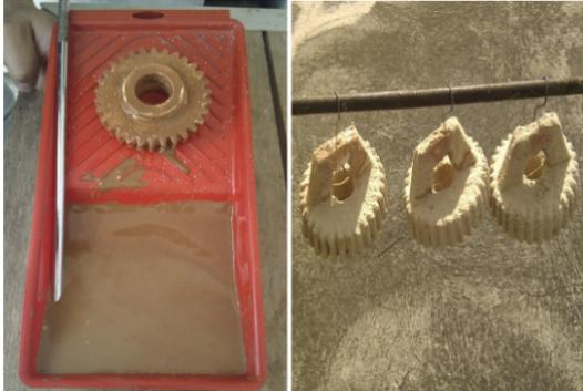
Figura 7: Aplicación de pintura refractaria y secado de modelos.
