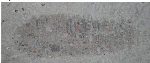
Figura 15. Zona de un adoquín con vidrio erosionada por la rueda abrasiva del equipo de ensayo de resistencia a desgaste.
