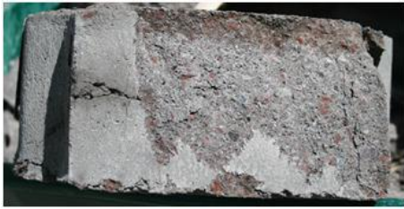
Figura 11. Plano de fractura de un adoquín tradicional
