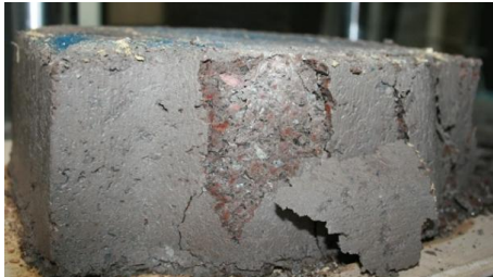
Figura 12. Plano de fractura de un adoquín con vidrio grueso ensayado a compresión.
