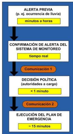
Figura 1. Proceso de un SAT [4]
