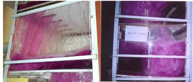
**Figura 10.** Características del flujo al interior del pozo de bandejas con rejillas para caudales bajos y altos (Escuela Politécnica Nacional, 2006)
