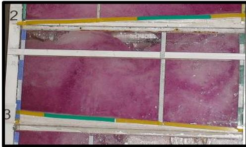
**Figura 14.** Comportamiento del flujo con caudal cercano al de diseño. Se observa la formación de la masa de agua, la gran turbulencia desarrollada y la introducción de aire. (Escuela Politécnica Nacional, 2006)
