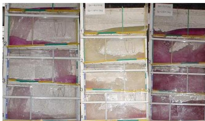
**Figura 13.** Características del flujo al interior del pozo de bandejas (reja con inclinación del 5%) con caudales a) bajo, b) medio y c) cercano al caudal de diseño (Escuela Politécnica Nacional, 2006)
