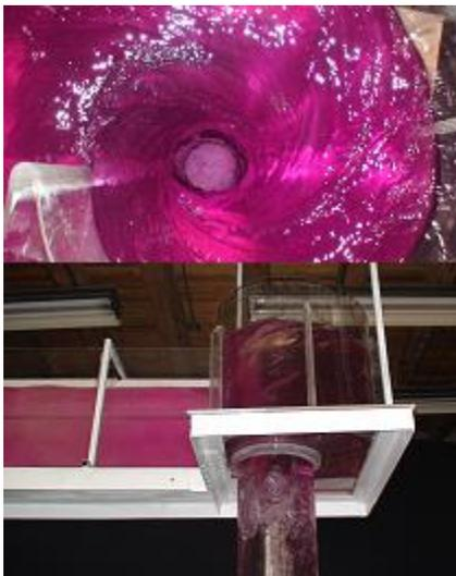
**Figura 15.** Comportamiento del flujo en a) la cámara de entrada con aproximación subcrítica del descargador a vórtice y en el b) canal de aproximación con caudales altos (Escuela Politécnica Nacional, 2006)
