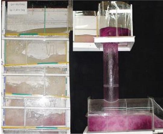
**Figura 18.** Funcionamiento de las estructuras para un caudal de operación aproximado del 62% del caudal de diseño. (Escuela Politécnica Nacional, 2006)
