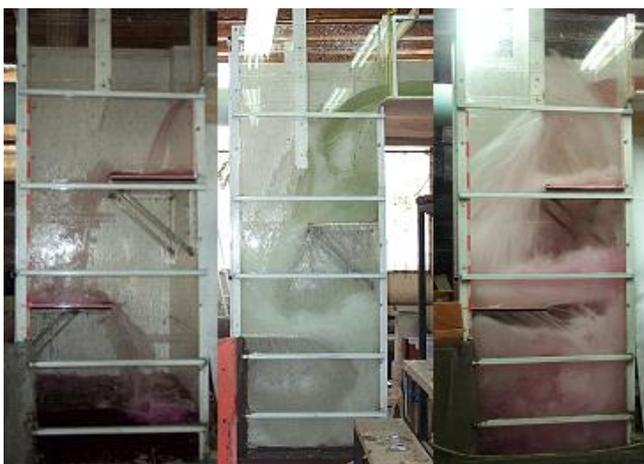
**Figura 9.** Características del flujo al interior del pozo de bandejas con diseño original con caudales bajos (<5% Qd), caudales medios (30% Qd) y cercanos al caudal de diseño (Escuela Politécnica Nacional, 2006)
