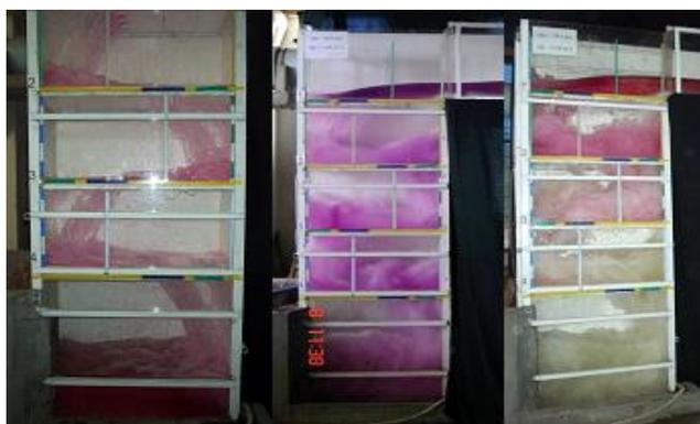
**Figura 11.** Características del flujo al interior del pozo de bandejas (reja – orificio) con caudales a) bajo, b) medio y c) cercano al caudal de diseño (Escuela Politécnica Nacional, 2006)
