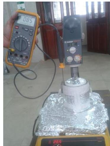
**Figura 3.** Proceso húmedo de mezcla asfalto-polvo de caucho
