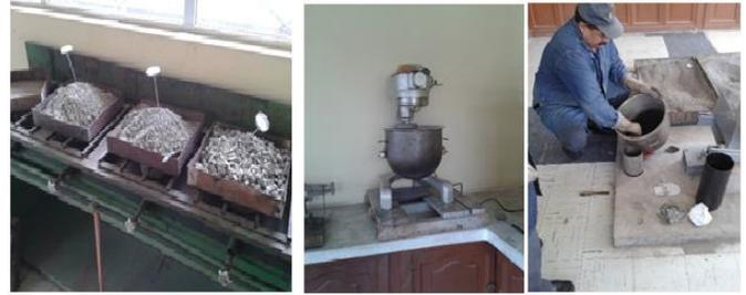
**Figura 2.** Proceso seco de mezcla asfalto-polvo de caucho
