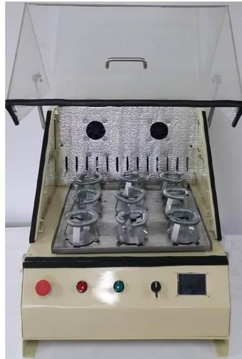
Figura 8. Prototipo final incubadora con agitación orbital propuesto
