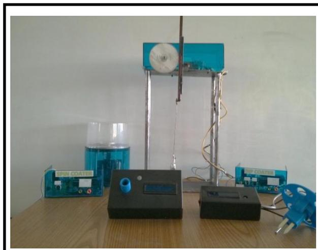
**Figura 2.** Equipos científicos construidos en nuestro laboratorio, en donde se ha aplicado aspectos de la tecnología disruptiva. De izquierda a derecha: *spin coater*, sensor de turbidez, *dip coater* y sensor de conductividad.
