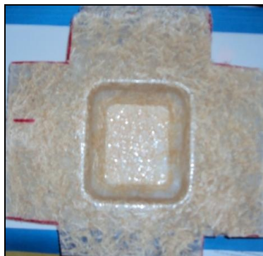
Figura 19. Bandeja unida al resto de la lámina de material compuesto.
