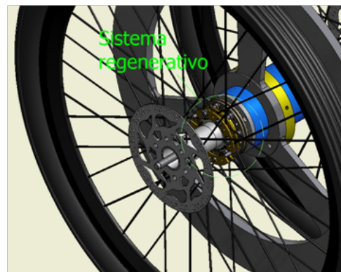
Figura 13: Ubicación y montaje del sistema regenerativo. Fuente: Propia.
