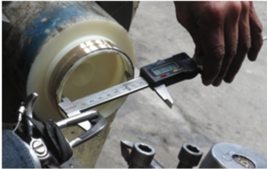
Figura 17: Anillos de conexión del motor eléctrico. Fuente: Propia.
