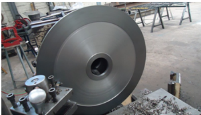
Figura 10: Fabricación del volante de inercia. Fuente: Propia.
