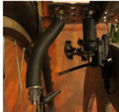
Figura 20: Sensor de revoluciones por minuto (rpm) del volante de inercia y sensor de velocidad (km/h) de la bicicleta. Fuente: Propia.
