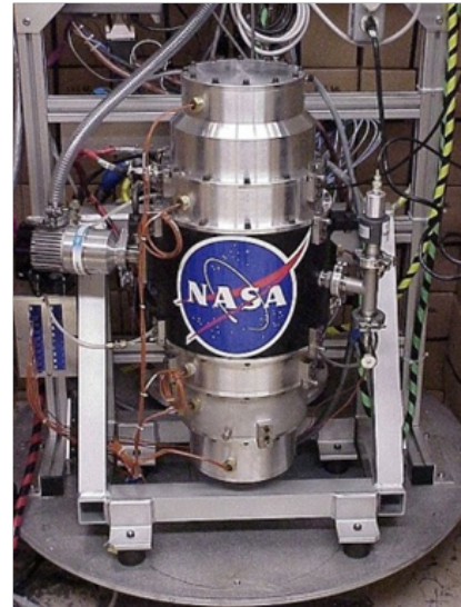
Figura 8: Batería Inercial desarrollada por la NASA [14].
