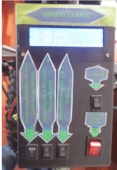
Figura 21: Tablero de control electrónico. Fuente: Propia.
