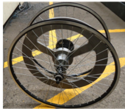
Figura 11: Fabricación del acumulador energético, montado en dos aros de bicicleta. Fuente: Propia.
