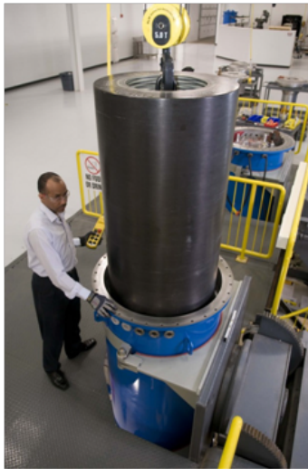
Figura 7. El rotor cilíndrico desciende hacia el recipiente de vacío [3].
