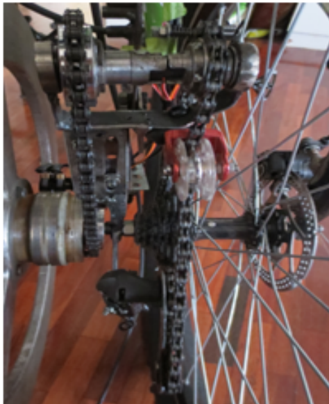
Figura 15: Construcción y montaje del sistema de transmisión. Fuente: Propia.
