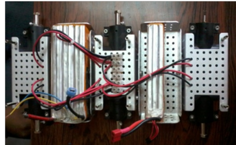
Figura 7: Chasis y motores de la plataforma terrestre.
