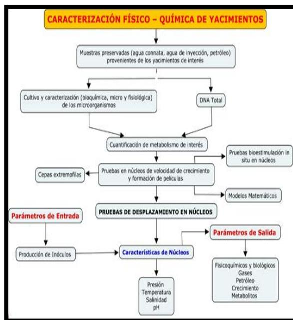
Figura 1. Diagrama del proceso de inyección bacteriana en la recuperación de petróleo.
