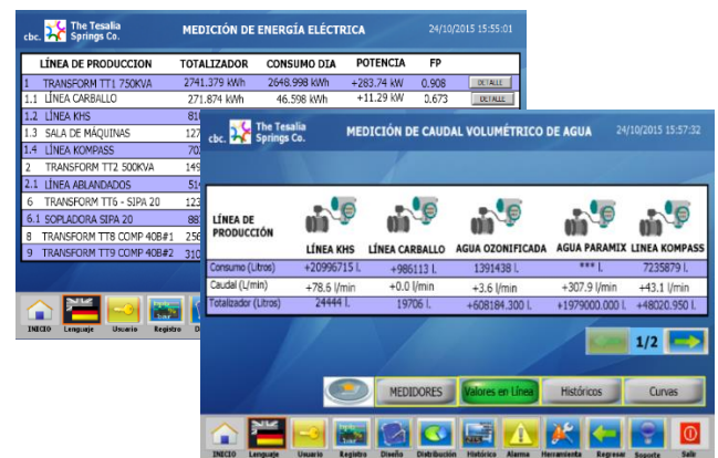
Figura 3. Ventana general de medición de energía eléctrica
