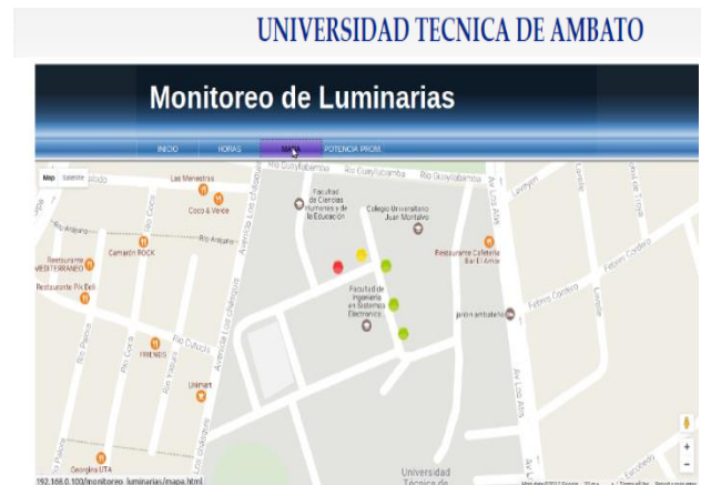
Figura 9: Interfaz web de localización geográfica de la luminaria integrada al control de iluminación
