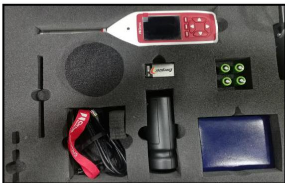
**Figura 3.** Sonómetro e implementos utilizados para muestreos en el CCICEV
