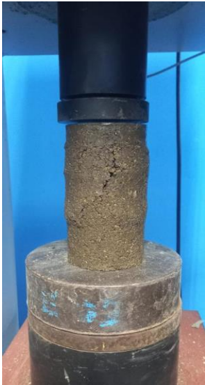
Figura 5. Prueba de compresión no confinada
